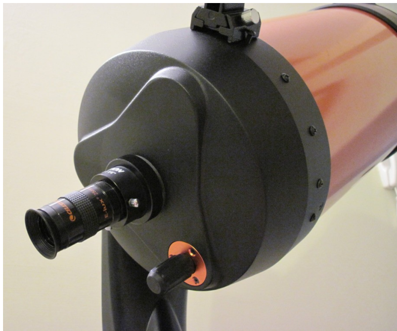
Fig. 2 - Il C8 con il solo visual back da 1.25". In tale semplice configurazione, il telescopio ha un rapporto d'apertura f/8.9
