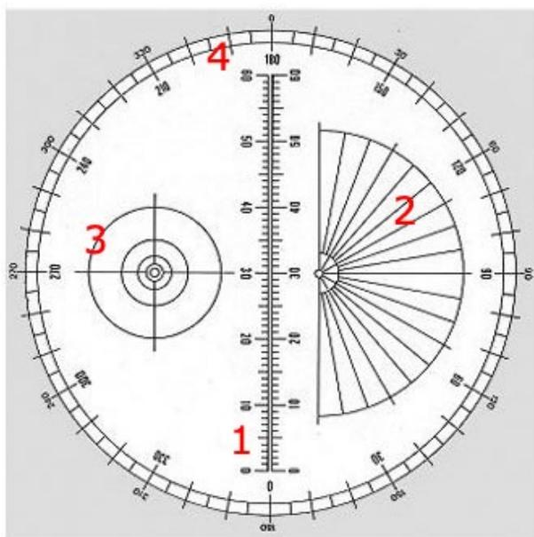
Molto semplicemente queste scale indicano: scala graduata lineare (1), scala semicircolare di angolo di posizione (2), cerchi concentrici per l'autoguida (3) e scala circolare per la misurazione degli angoli (4).
