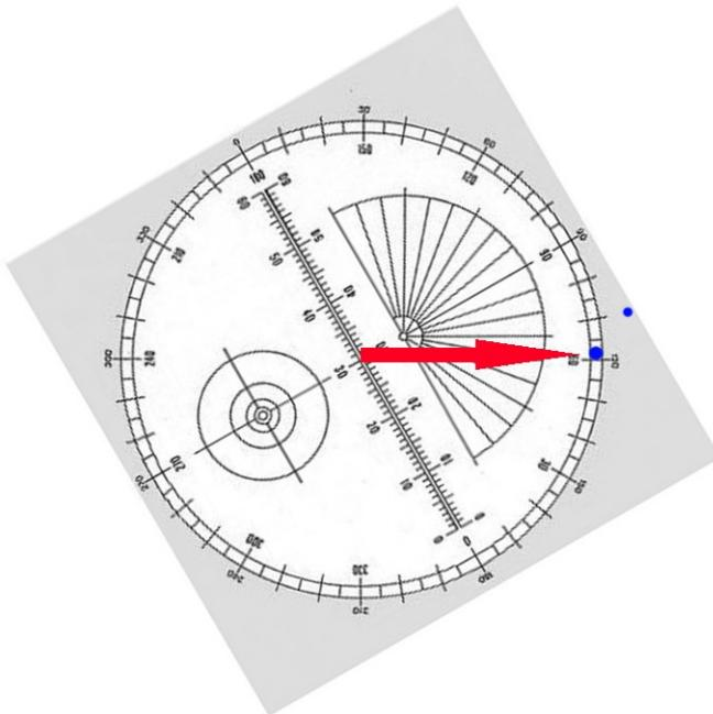
3) Ruotare l'oculare affinché la componente primaria coincida con  $90^\circ$  (o  $270^\circ$ ):
